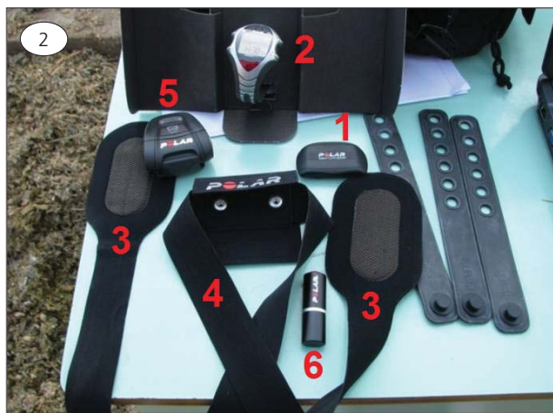
2. ábra. Polar Equine mérőberendezés tartozékaival 1 – HR-jeladó; 2 – HR-vevőkészülék; 3 – elektróda; 4 – elektródahám; 5 – GPS; 6 – Polar infravörös USB illesztőegység a számítógépes adatátvitelhez
